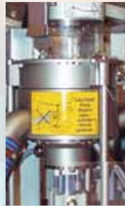
Im Mahlgradmodul garantiert ein Ultraschallreinigungselement daß die Meßzelle gereinigt und für die nächste Messung bereit ist.
