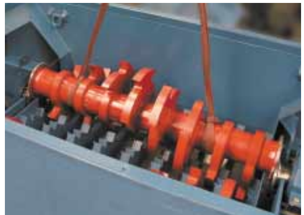
Connection à brides des outils de coupe des rotors
