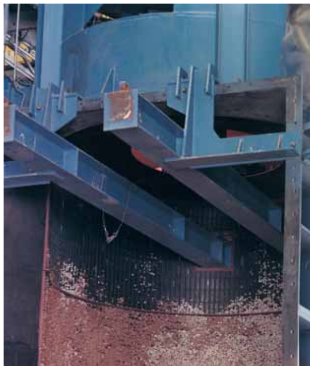
Revestimento magnético Orebed no Moinho Vertical (VERTIMILL®) VTM-1250-WB
