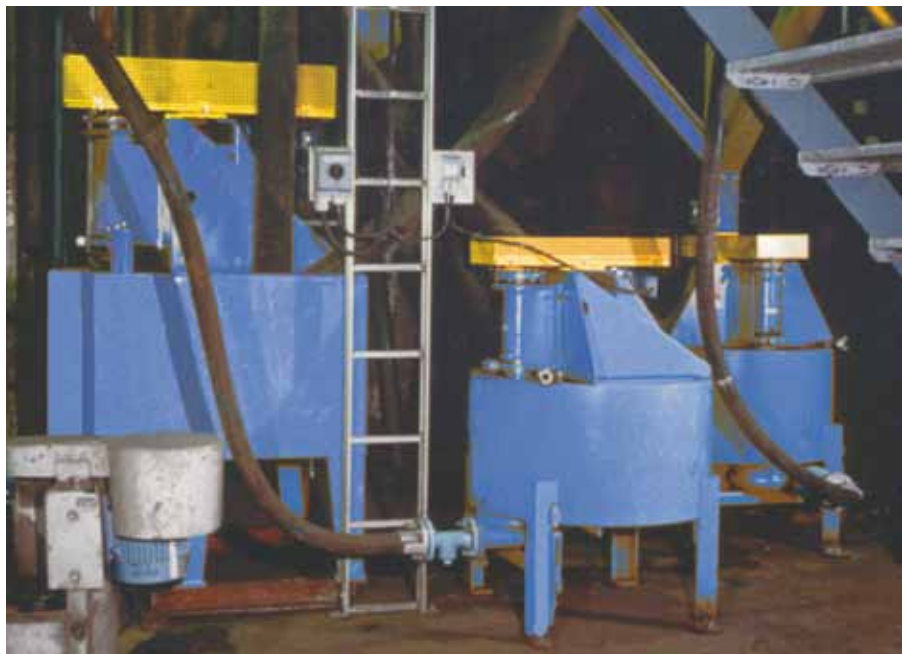
Metso VT bombas para el bombeo de concentrados, mixtos y relaves de espirales para el tratamiento de la escoria <2 mm.
