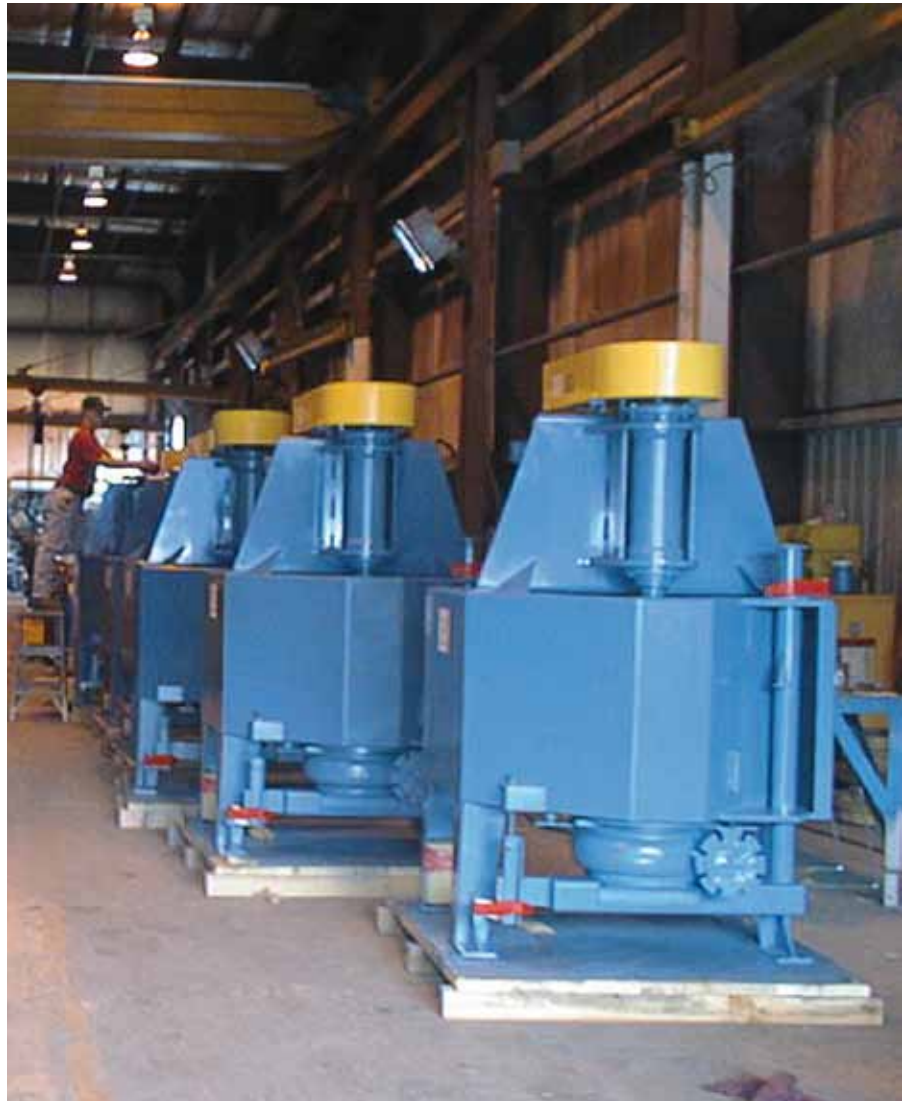
Bomba VT 100 durante el montaje
