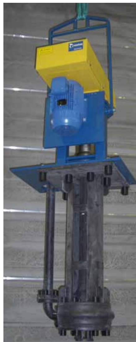
Кислотоупорная версия с участком всаса, покрытым натуральным каучуком или хлоропреном
