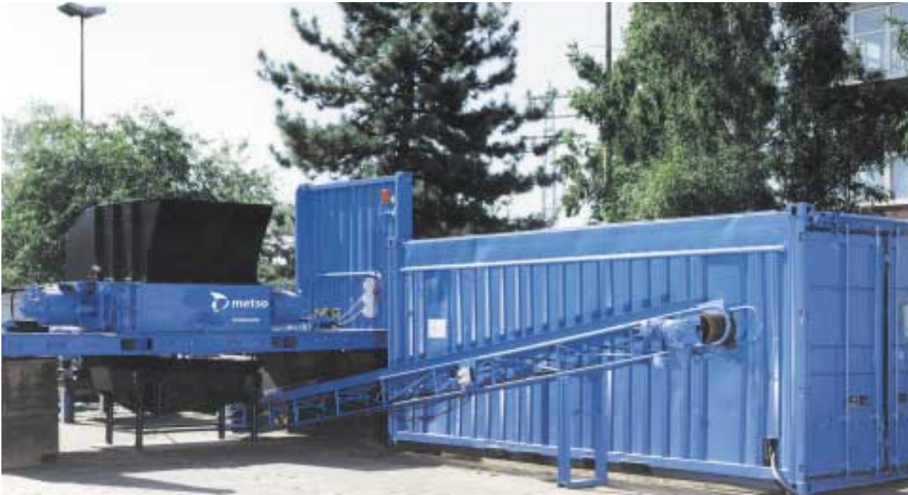
Sur les cisailles à rotors des types RO 10-5 à RO 22-8 deux unités ISO 20' permettent une manutention sans problème en cas de changement du site d'utilisation.
