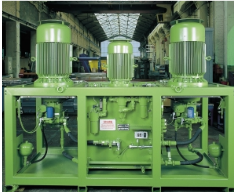
Le circuit hydraulique fermé minimise les besoins en service et maintenance
