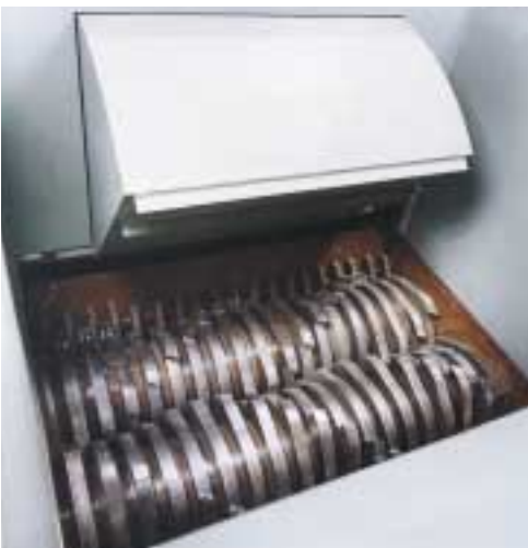
Sur les produits mobiles à entraînement électrique l'élément de poussoir augmente le rendement en présence de matériel volumineux.
