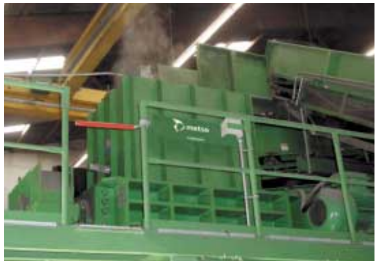
RO 16-6M avec entraînement électrique : Installation de traitement de caoutchouc usé
