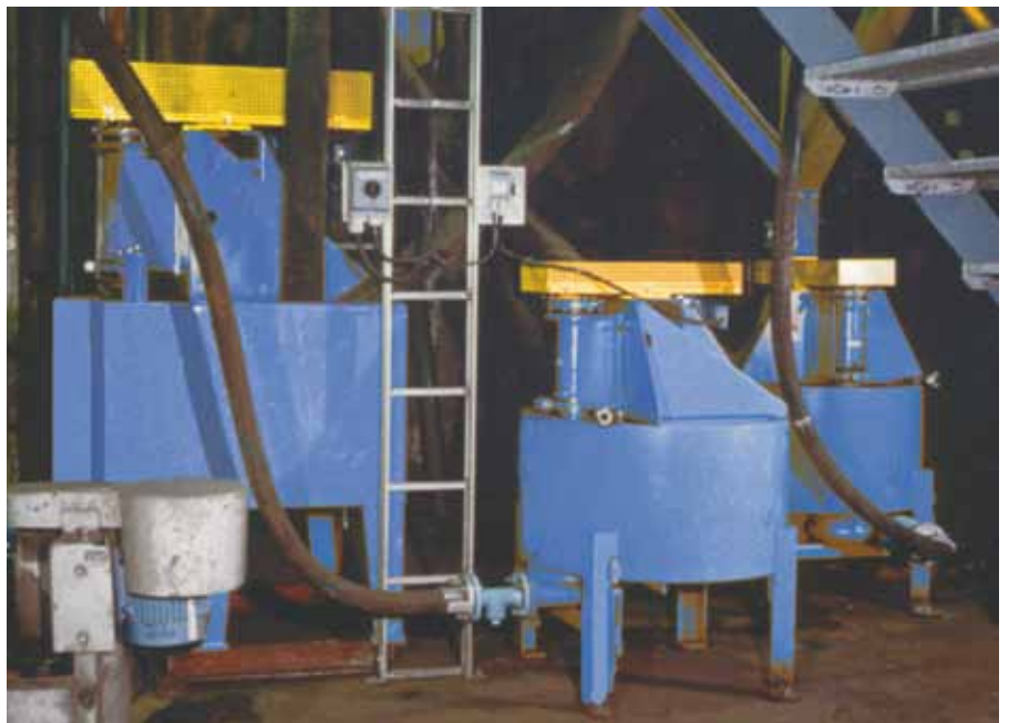
Metso VT Pumpen zum Pumpen von Konzentrat, Zwischengut und Haldenabfall von Spiralen zur Bearbeitung von Schlacken < 2 \text{ mm} .
