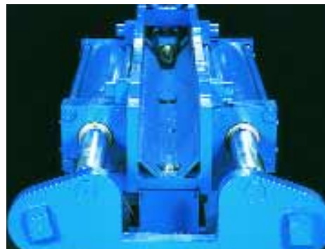
Système hydraulique pour le démontage des axes de marteaux
