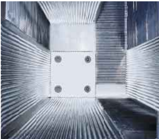
Tôles d'usure avec profil particulier pour augmenter la sécurité des opérations
