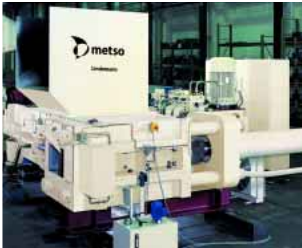
Presse à paqueter à double action RAS II
