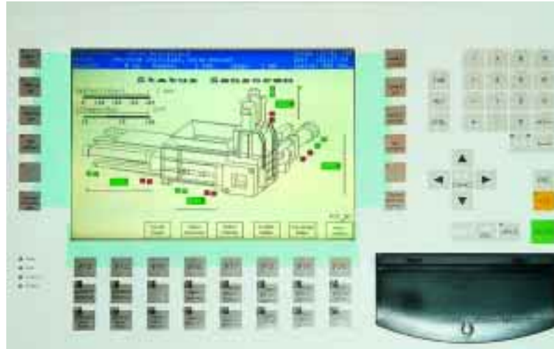
Terminal multifonctions pour affichage des données opérationnelles et aide on-line
