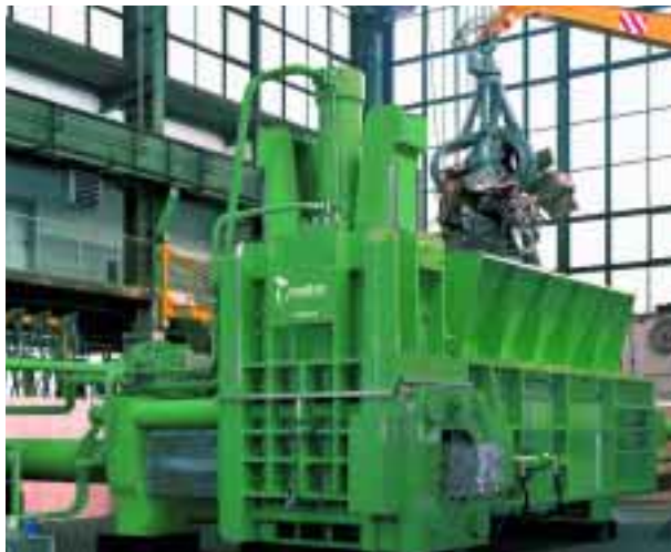
Presse à paqueter à triple action RAS III
