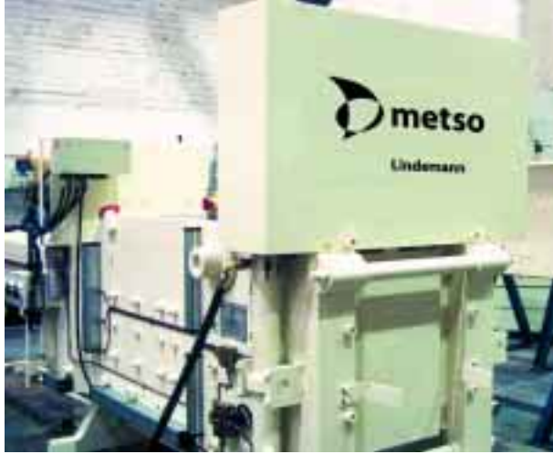
Presse à paqueter à simple action RAS I
