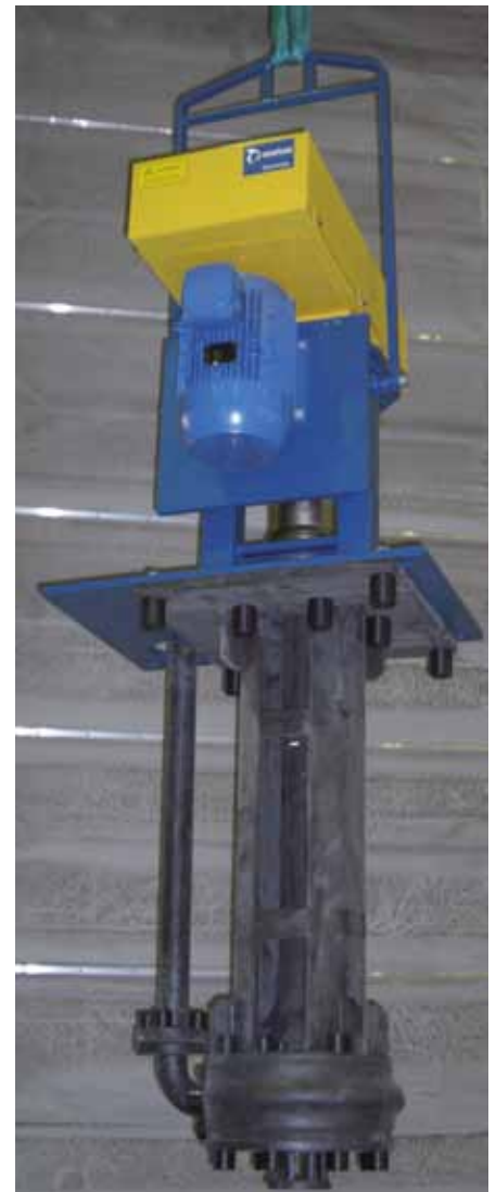
Versão resistente a ácidos com todas as partes úmidas integralmente cobertas de borracha natural ou cloropreno.
