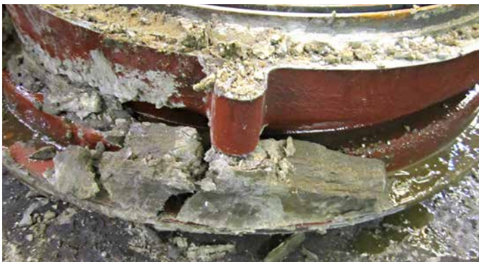
Balourd rempli de fines agglomérées provoquant un déséquilibre important de l'ensemble tournant.
