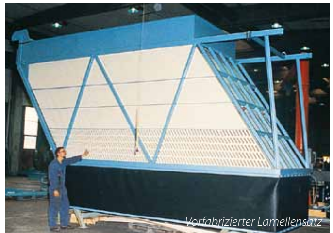
Robuster Schrägplatteneindicker mit radial angeordneten Lamellensätzen.
