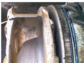
Figure 2 - Usure des aubes par tourbillons - Travail en-dessous du BEP
