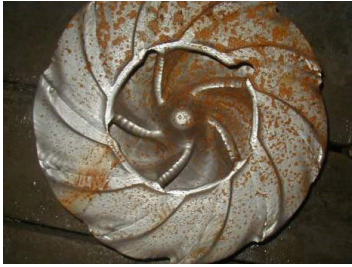
Figure 3 - Voile avant éventré suite à un fonctionnement en-dessous du BEP
