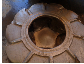
Figure 4 - Usure par impact – Travail au-dessus du BEP
