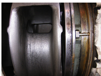
Figure 1 - Usure régulière des aubes - Travail proche du point de meilleur rendement (BEP)
