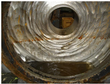
Figure 5 - Usure de type « dunes de sables »
