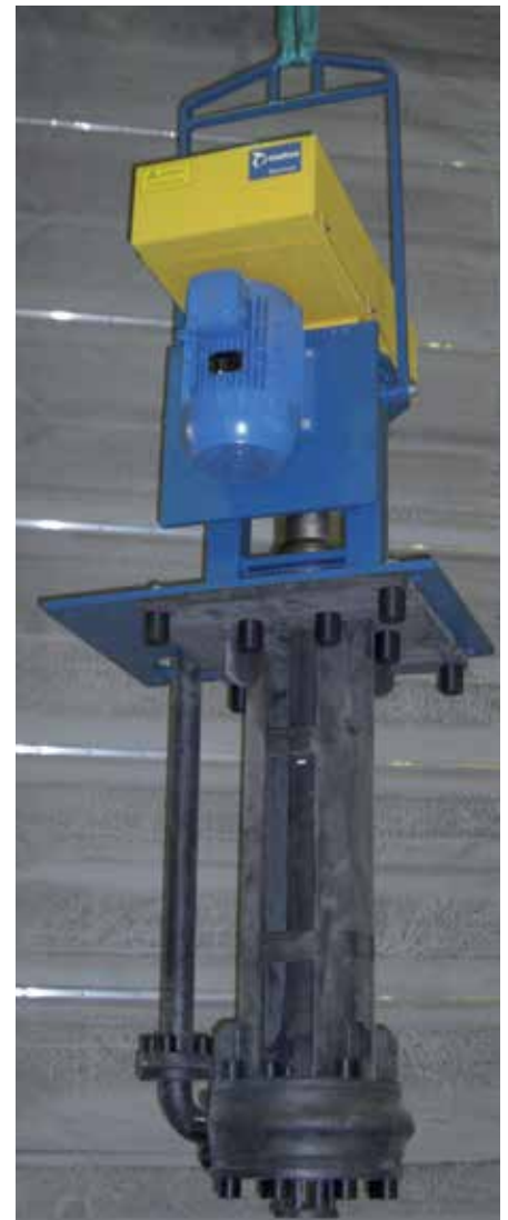
Säurebeständige Version, alle Nassteile sind vollständig mit Naturgummi oder Chlorobutyl beschichtet.
