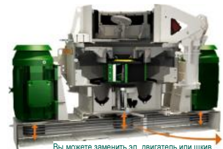
Вы можете заменить эл. двигатель или шкив дробилки для изменения скорости ротора
