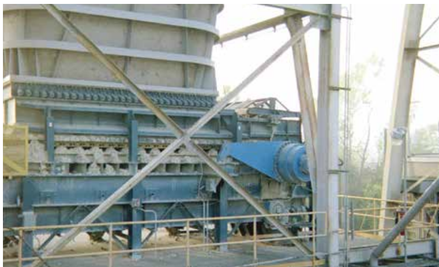
Alimentador de sapatas em um importante produtor de cimento retomando argila de um silo de estocagem.
