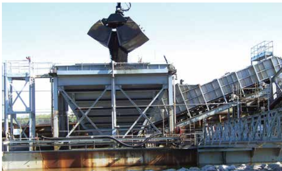
Alimentador de Sapatas retomando carvão de uma tremonha em uma barcaça para alimentar uma importante usina termoeleétrica.
