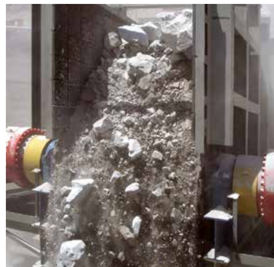
Alimentador de Sapatas retomando minério de cobre de uma tremonha para um britador giratório.
