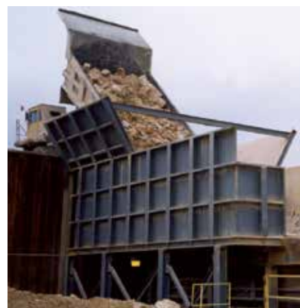
Tremonas de descarga de caminhões utilizam os Alimentadores de Sapatas Metso para retomar rocha e minério a uma taxa controlada de velocidade para alimentar outros equipamentos, como todos os tipos de britadores, grelhas vibratórias, peneiras vibratórias, alimentadores tipo "wobbler" ou transportadores de correia.
