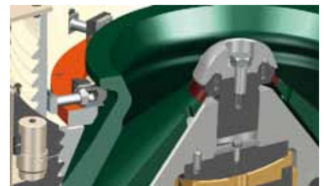
Fixação do revestimento
