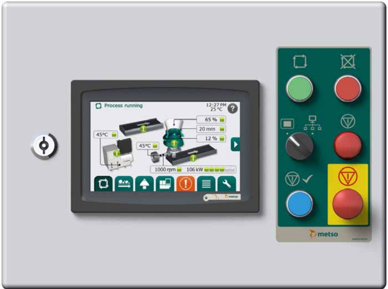
L'utilisation de l'automatisation Metso IC est facile et sûre. La mise en route et l'arrêt du processus sont assurés en appuyant sur un seul bouton.
