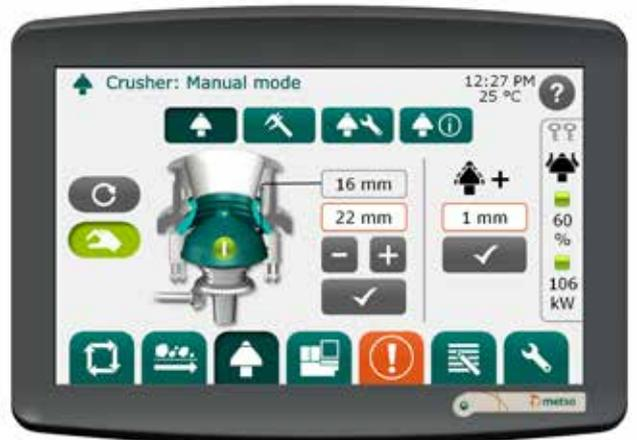
L'automatisation Metso IC optimise le contrôle de l'appareil et ajuste automatiquement le processus de broyage.
