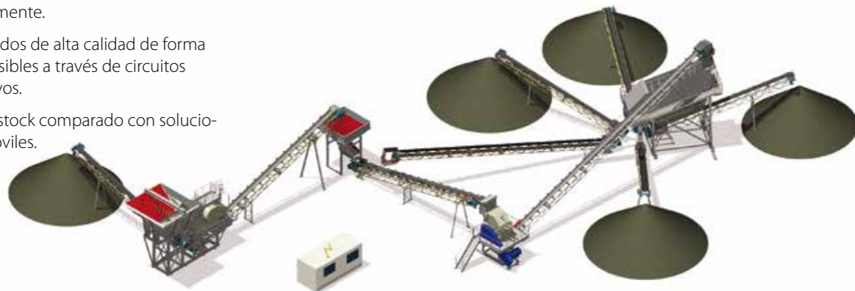
Ejemplo de planta completa Nordplant N° 4 para aplicaciones en rocas blandas.
