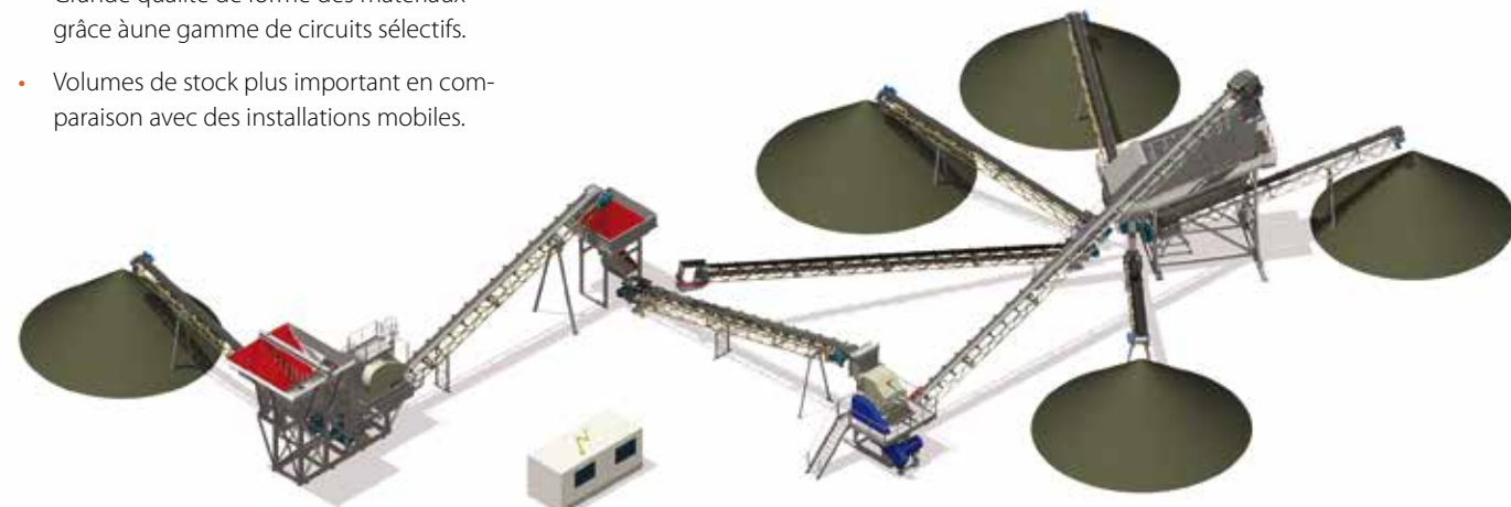
Nordplant N°4: solution pour roche peu abrasive : le concasseur à percussion NP.
