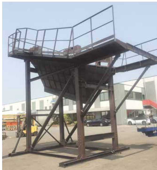
Le pré-assemblage de la structure avant peinture garantit la rapidité et la qualité du montage sur site.
