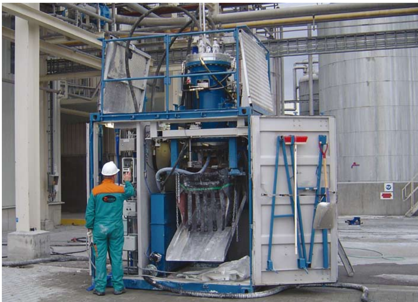
コンパクト設計で簡単据付けのブースター・レンジ。このようにコンテナ内に設置すれば、移動や一時的な処理が可能。
